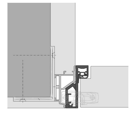
Blockzargen »BZS« und »BZSI« mit minimalistischer Konstruktion für 60-Millimeter-Türen, variabel einsetzbar mit Spiegelbreite 18 Millimeter sowie verdeckter Bandausführung (Bilder: Küffner).
