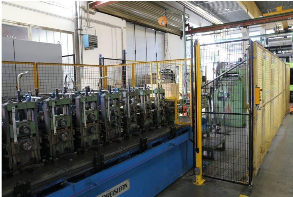
Bei den Schutzzäunen gibt es nach dem Retrofit einen Mix aus Alt und Neu. Überall dort, wo sicherheitstechnisch nachgerüstet werden musste, sorgen jetzt Sicherheitslichtgitter »PSENopt II« von Pilz für einen normkonformen Finger-, Hand- und Körperschutz (Bild: Pilz).
