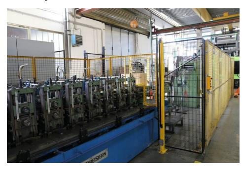
Bei den Schutzzäunen gibt es nach dem Retrofit einen Mix aus Alt und Neu. Überall dort, wo sicherheitstechnisch nachgerüstet werden musste, sorgen jetzt Sicherheitslichtgitter »PSENopt II« von Pilz für einen normkonformen Finger-, Hand- und Körperschutz (Bild: Pilz).
