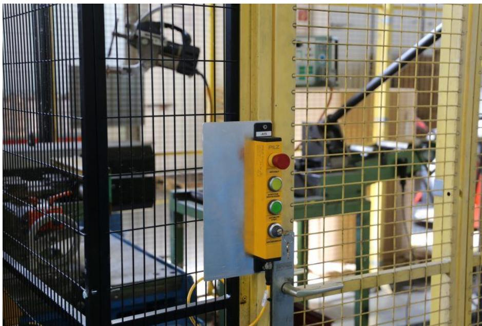
Robust und einfach zu montieren bzw. zu bedienen: die Taster-Unit »PITgatebox«, über die sich Schutztürsysteme flexibel ansteuern und Anlagen per Knopfdruck aktivieren, stoppen und quittieren lassen (Bild: Pilz).
