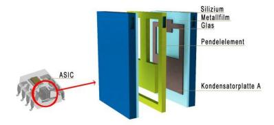
Schematischer Aufbau eines Neigungssensors der Reihe »KAS« (Bild: a.b.jödden).
