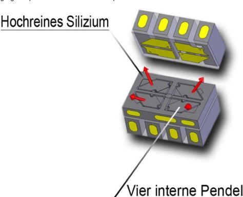
Blick ins Innenleben des MEMS-Sensors (Bild: a.b.jödden).
