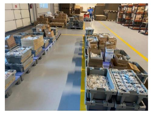
Platz- und kostensparend: Der polnische Möbelfabrikant setzt auch Drehstapelkästen aus Kunststoff für die Lagerung und den Transport von Verbindungsbeschlägen aus Metall ein (Bild: Craemer).
