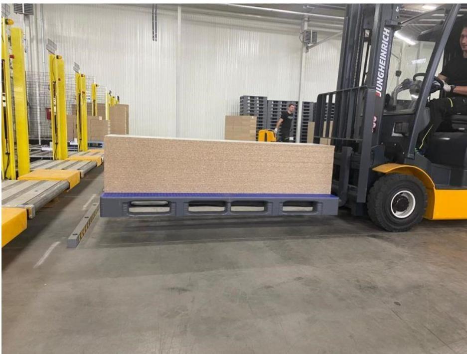
Rutschfestes Oberdeck: Die vollflächige Antirutschbeschichtung verhindert das Verrutschen der glatten Spanplatten (Bild: Craemer).
