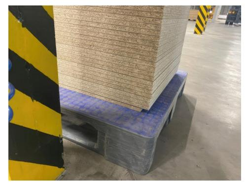
Langlebig: Auch nach zwei Jahren Dauereinsatz ist die Kunststoffpalette in einem sehr guten Zustand und hält selbst bei verstaubter Oberfläche die Ladung (Bild: Craemer).
