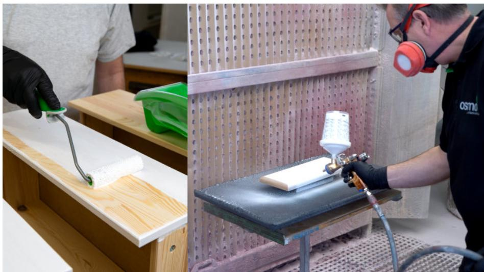
Der Porenfüller schließt zuverlässig Holzporen, Risse sowie kleinere Unebenheiten
