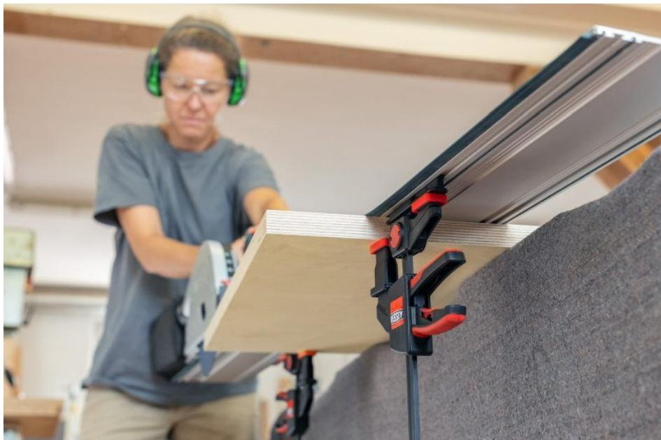
Die Einhand-Tischzwinge unterstützt Führungsschienen von Festool, Protool, Metabo, Makita, Hitachi/Hikoki, Dewalt, Bosch und Mafell (Bild: Bessey).
