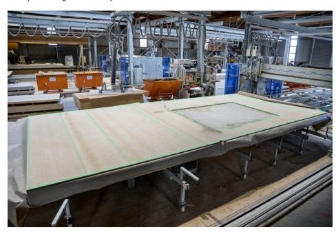
Laserprojektionssysteme unterstützen bei der Optimierung unterschiedlicher Prozesse wie bei dieser fertig genagelten Wandplatte (Bild: SL-Laser).
