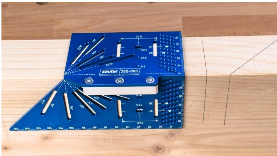
Kompakt im Format, groß in der Anwendung: Die neue Anreißschablone erlaubt vielfältige Markierungen zum Anzeichnen von Scharnierlöchern (System 32), Eckverbindungen und Winkelmaßen (Bild: [sauter](#)).
