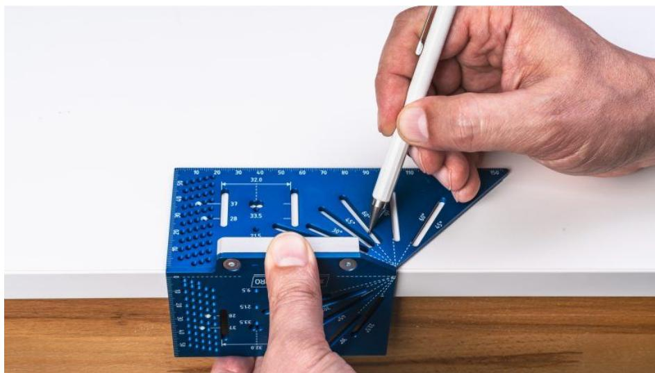
Sehr hilfreich sind die eingefrästen Standardwinkel, deren Ursprung im Schnittpunkt der beiden Seiten liegt (Bild: sauter).
