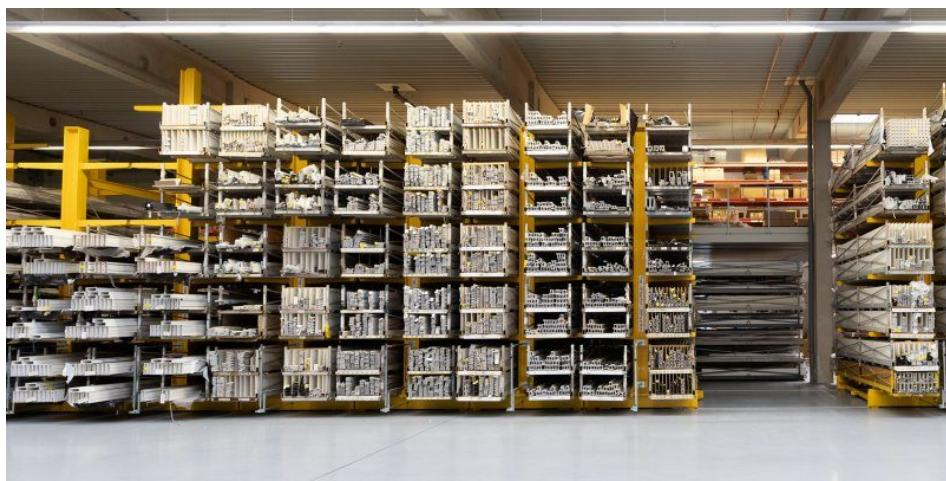
In den quer verfahrbaren Langgutlagern erweitern verschiedene Lagermodule die Funktionalität, beispielsweise zur Lagerung von Einzelprofilen und Bündelware (Bild: Hegla).
