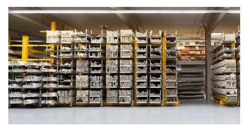
In den quer verfahrbaren Langgutlagern erweitern verschiedene Lagermodule die Funktionalität, beispielsweise zur Lagerung von Einzelprofilen und Bündelware (Bild: Hegla).
