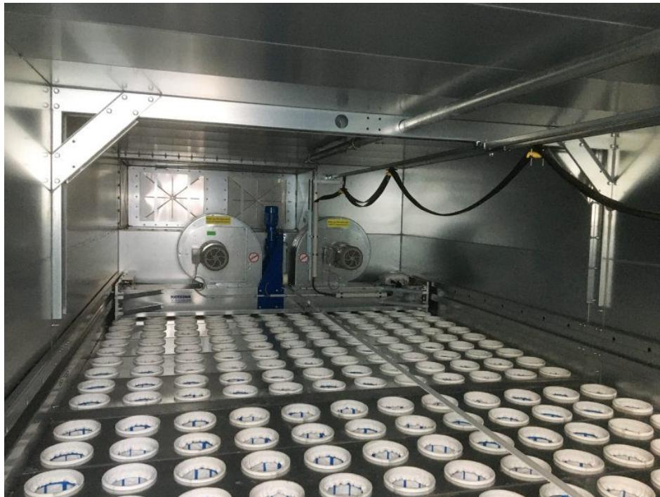
Die kontinuierliche Abreinigung des Filtermaterials mittels SpülLuft sorgt für konstant hohe Filterleistung (Bild: Höcker Polytechnik).
