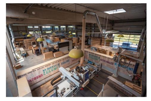
Die Raumaufteilung der Zebrano-Werkhalle ist bis ins Detail durchdacht, dem passt sich die Rohrleitungsführung für die Absauganlage »Profi Jet« von AL-KO an (Bild: AL-KO).
