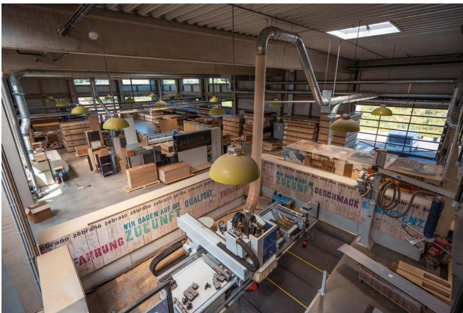
Die Raumauflistung der Zebrano-Werkhalle ist bis ins Detail durchdacht, dem passt sich die Rohrleitungsführung für die Absauganlage »Profi Jet« von AL-KO an (Bild: AL-KO).
