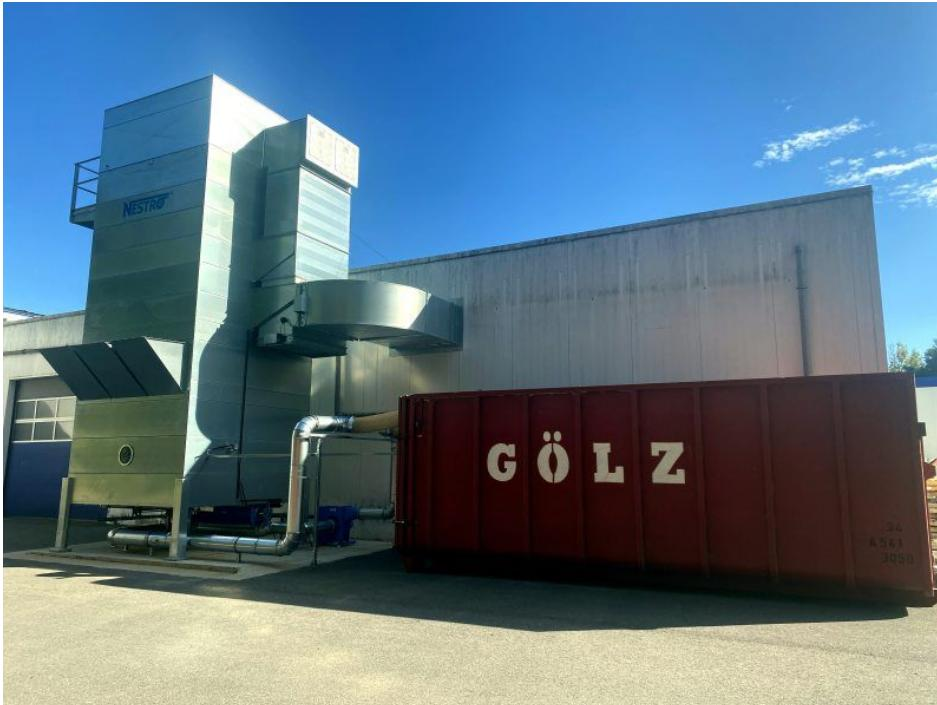
Das Material wird aus dem Tageslager des Filterhauses in einen Durchblascontainer ausgetragen (Bild: Nestro).
