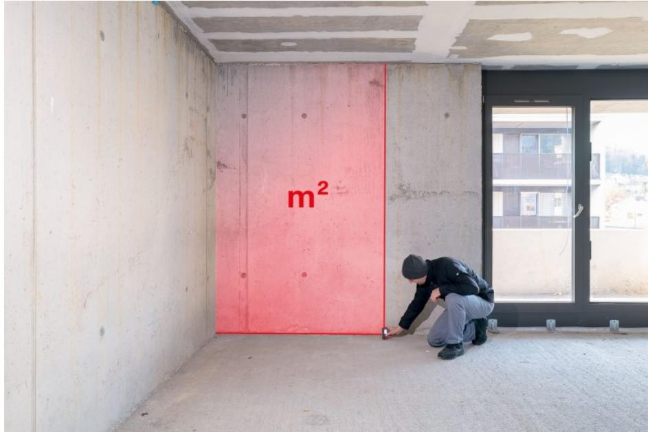
Mit dem Laser-Entfernungsmesser können auch schnell Flächen berechnet werden (Bild: Sola).
