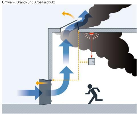
Mithilfe des besonderen Türschließers wird die Gebäudeeingangstür zur riesigen Zuluftklappe (Bild: Eco Schulte).
