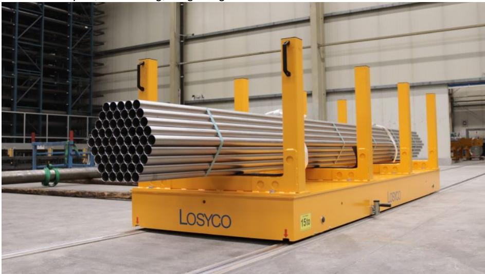
Flurebene Bodenschienen und kundenspezifische Transportwagen erleichtern die Lagerlogistik im Hallenverbund (Bild: Losyco).
