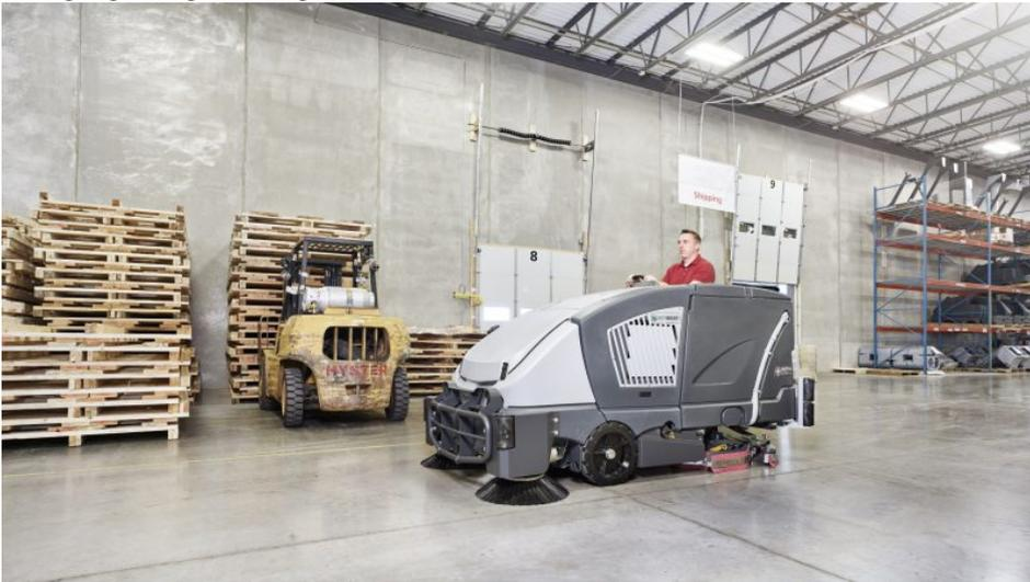
Mit dem doppelseitigen Bürstensystem in 154 cm Breite ist die Kombinationsmaschine für die Großflächenreinigung geeignet (Bild: Nilfisk).
