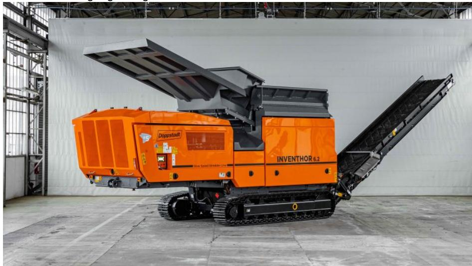
Der Zerkleinerer verfügt über einen optimierten Klapptrichter, der das Beladen mit Bagger oder Radlader vereinfacht (Bild: Doppstadt).
