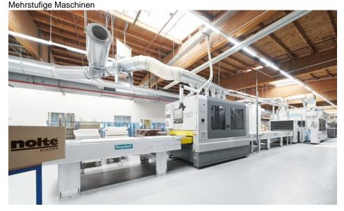
Beschichtungslinie von Venjakob inklusive Entstaubungsanlage, Förder- und Trocknungstechnik (Bild: Nolte).
