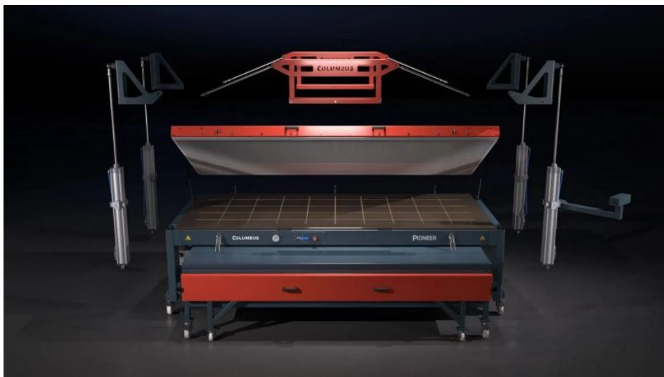
Die Vakuumpressen sind modular aufgebaut und lassen sich daher einfach erweitern (Bild: Columbus).
