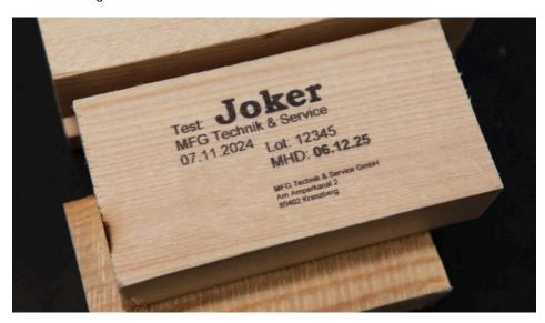
Der Tintenstrahldrucker eignet sich auch für die direkte Kennzeichnung von Holz (Bild: MFG).
