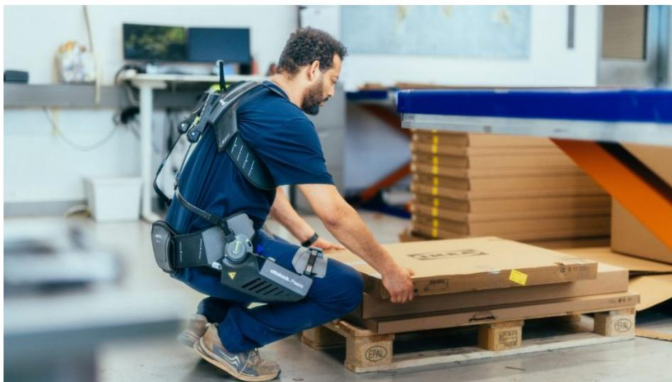
Exoskelette von Ottobock entlasten das Personal an den Arbeitsplätzen (Bild: IKEA/Ingka).
