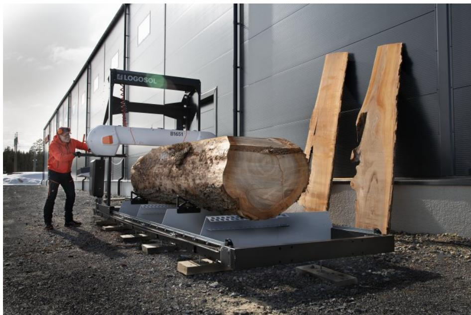
Die besonders stabile Blockbandsäge ist für Anwender geeignet, die effizient Slabs mit bis zu 1500 mm Breite sägen möchten (Bild: Logosol).
