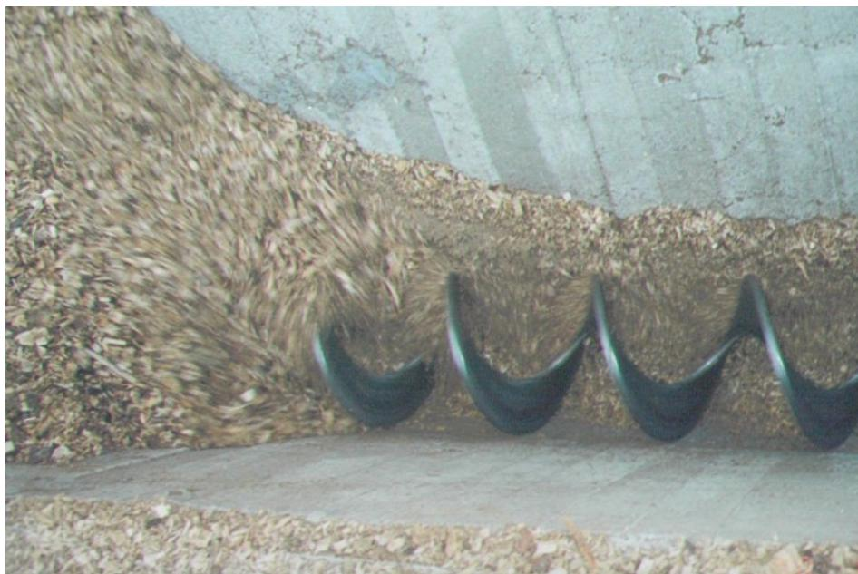
Mit den achsenlosen Förderspiralen erfolgt der Transport der Hackschnitzel effizient und wartungsarm (Bild: Wildfellner).
