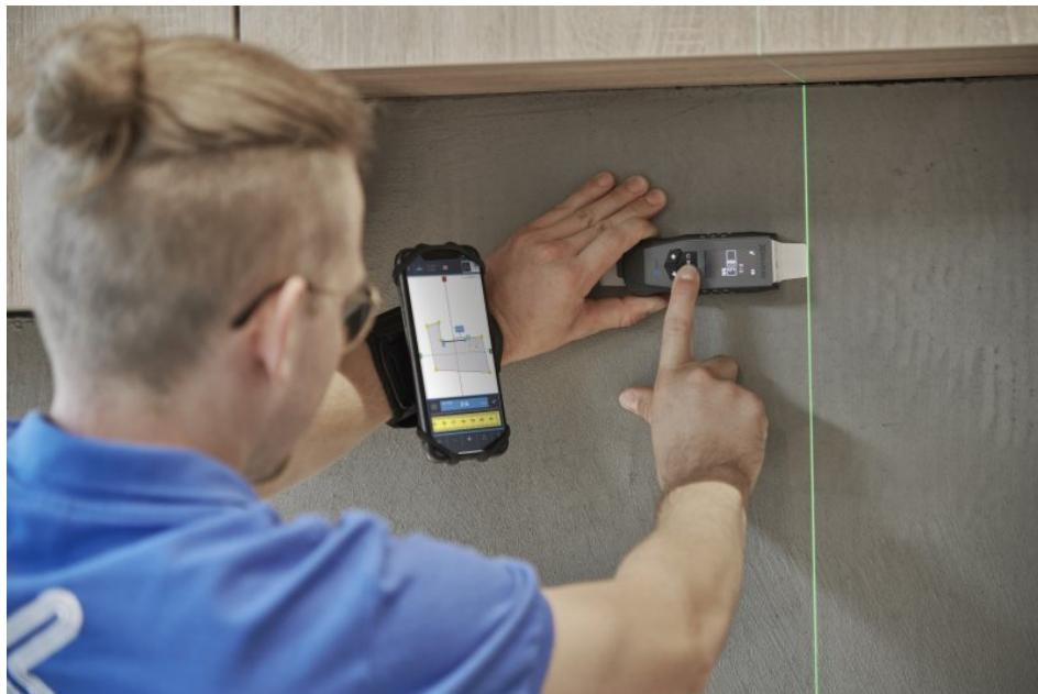
Die vom digitalen Aufmaßsystem gemessenen Daten werden automatisch via Bluetooth in die Aufmaß-App übertragen (Bild: Solaflex).
