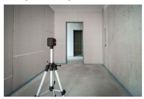
Der grüne Linienlaser ermöglicht ein großes Linienpanorama bis zu 170° für vielseitige Anwendungen im Innenausbau (Bild: Sola).
