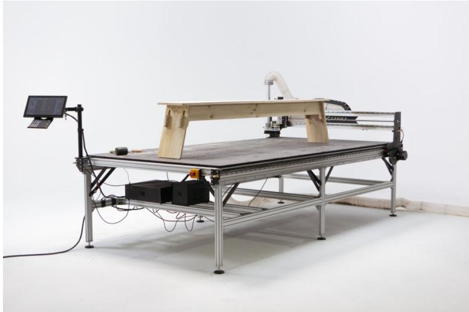
Mit ihrem Open-Source-Design ist die CNC-Fräsmaschine besonders für kleine und mittlere Betriebsgrößen geeignet (Bild: sautershop)
