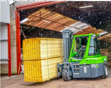
Der Elektro-Mehrwegestapler »Combi-CB70E«, ist trotz einer Tragfähigkeit von sieben Tonnen besonders kompakt ist und kann auch in engen Gängen manövrieren (Bild: Combilift).
