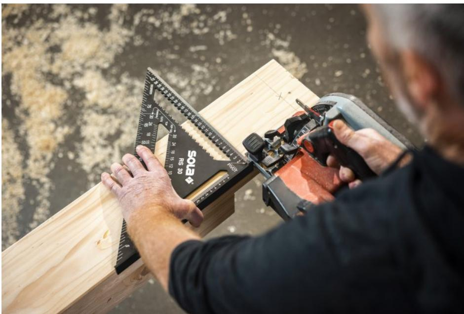
Dank der robusten Kante kann der Sparrenwinkel »RS« auch als Sägeführung verwendet werden (Bild: Sola).
