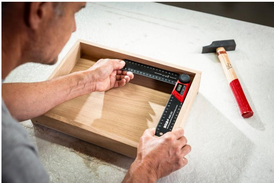
Der digitale Winkelmeßgeräte misst Innen- und Außenwinkel mit einer Genauigkeit von  $\pm 0,3$  Grad (Bild: Sola)
