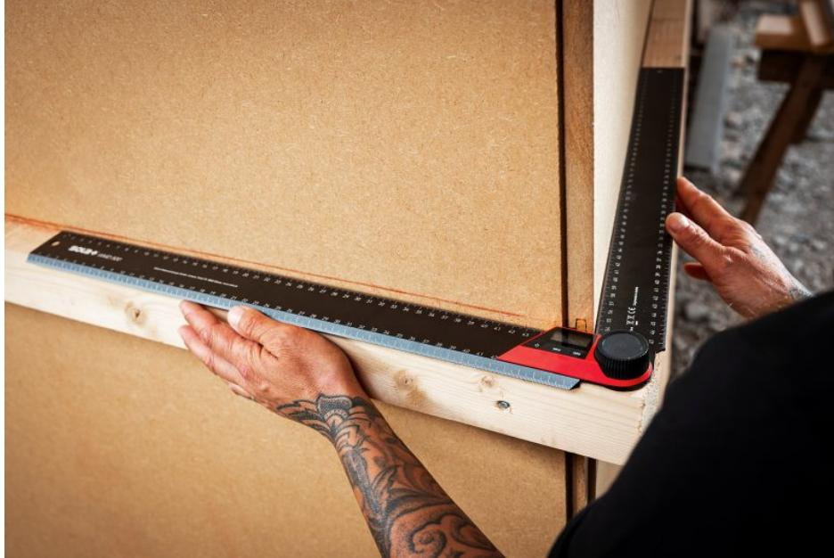
Beispiel für die Messung eines Außenwinkels mit der 500-Millimeter-Variante (Bild: Sola).
