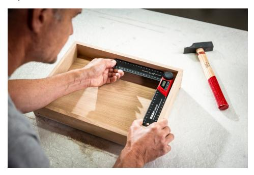
Der digitale Winkelmesser misst Innen- und Außenwinkel mit einer Genauigkeit von  $\pm 0.3$  Grad (Bild: Sola)
