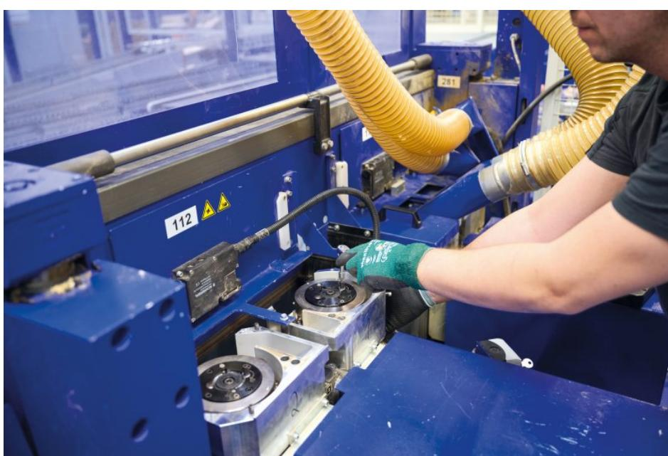
Mithilfe eines Inbusschlüssels und einer kleinen Drehung wird der neue und scharfe Schneidenbereich am Fräser eingestellt. Daraus resultieren minimaler Maschinenstillstand, maximale Werkzeugnutzung und bestmögliche Produktqualität (Bild: Leuco).
