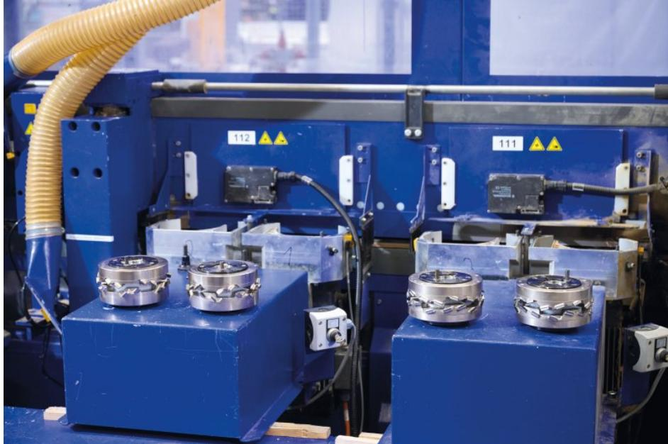
Links im Bild »Diarex«-Fräser und rechts »p-System«-Fräser, beide mit innovativer Verstelltechnik (Bild: Leuco).
