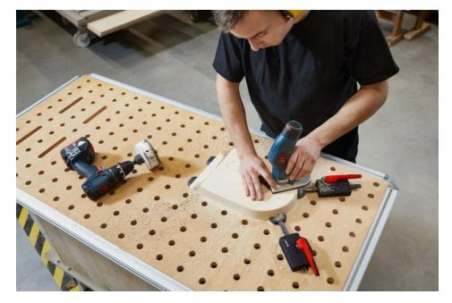
Die Waagrechtspanner verfügen über eine spezielle Niederzugmechanik, die dafür sorgt, dass das Werkstück plan auf der Tischplatte gehalten wird (Bilder: Bessey).
