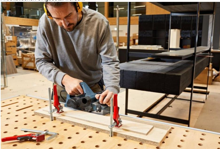
Die Tischzwinge mit Hebelgriff spannt mit bis zu 240 kg (Bilder: Bessey).
