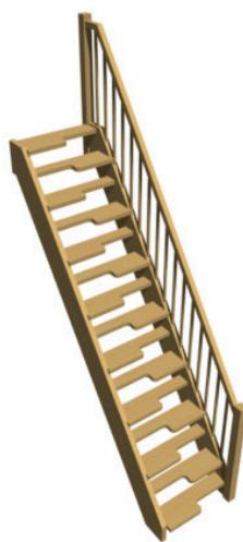
Die Raumspartreppe nutzt zwei Stufenformen jeweils abwechselnd über die gesamte Treppe (Bild: Kessel EDV-Systeme).
