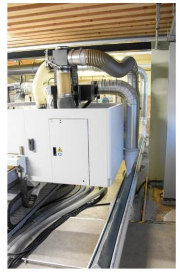
Aufgrund des limitierten Platzangebots wurde die Absaugung in Form eines Lippenrohrs installiert (Bild: Scheuch Ligno).
