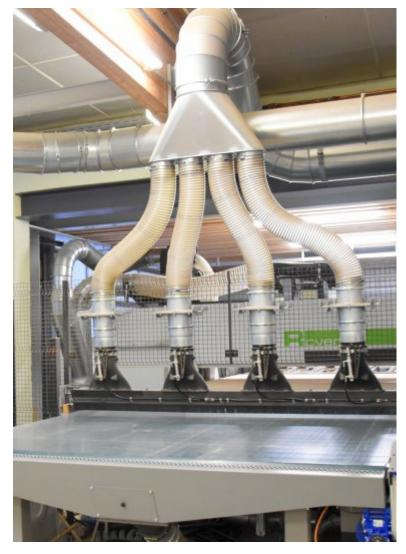
Sind die Platten von der CNC fertig bearbeitet, werden sie beim Herausschieben von der Absaugung mit Bürsten gereinigt (Bild: Scheuch Ligno).
