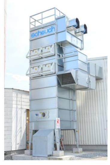
Die bei der Tischlerei Manigatterer installierte Absauganlage arbeitet mit einer Absaugleistung von 33.000 Kubikmetern pro Stunde (Bild: Scheuch Ligno).
