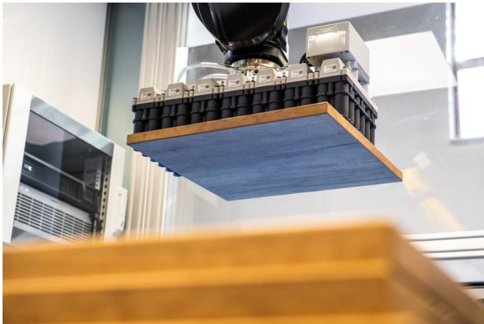
Das »Solution Kit ivos Wood« übernimmt monotone Tätigkeiten und entlastet die Belegschaft (Bild: J. Schmalz GmbH).
