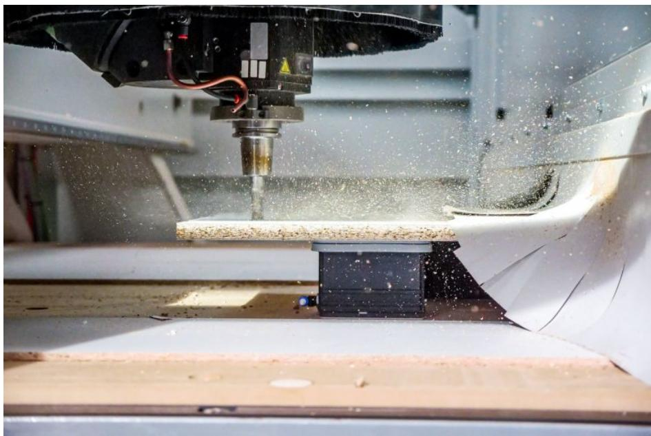
Dieser neue Blocksauger fixiert Massivholz bei anspruchsvollen Anwendungen auf Nestingtischen durch den einteiligen Aufbau und den zusätzlichen Vakuumanschluss (Bild: Schmalz).
