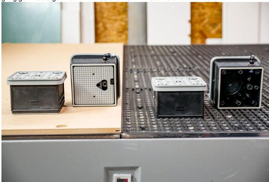
Die neuen Blocksauger der Reihe »VCBL« eignen sich gleichermaßen für Nesting- und Rastertisch-Anwendungen (Bild: Schmalz).
