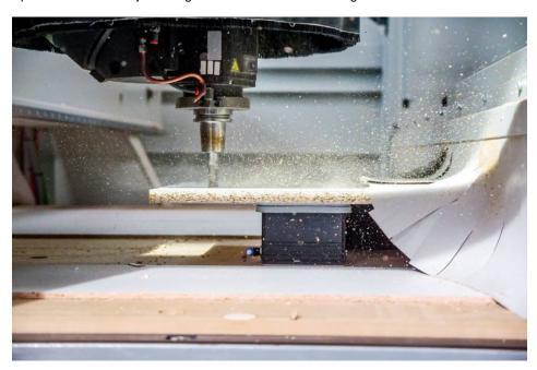
Dieser neue Blocksauger fixiert Massivholz bei anspruchsvollen Anwendungen auf Nestingtischen durch den einteiligen Aufbau und den zusätzlichen Vakuumanschluss (Bild: Schmalz).
