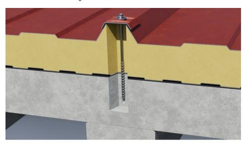
Ohne Einlegeschiene können dank der ETA-zertifizierten Betonschraube Sandwichelemente direkt in Beton befestigt werden (Bild: EJOT).
