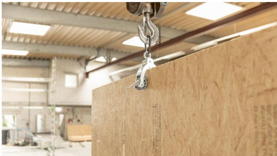
Der neue Kranplattenheber trägt z. B. Holzplatten bis zu einem Gewicht von 130 kg
