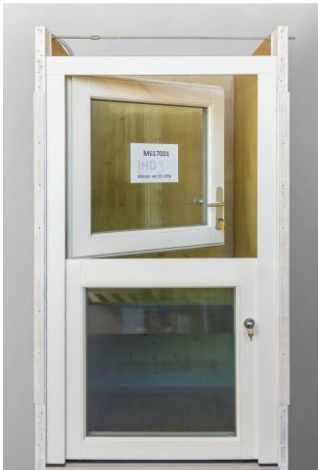
Prüfkörper der Ausführungsvariante mit Schwelle, zweiteilige Klöntür (Rettungsöffnung) nach außen öffnend (Bild: Variotec).
