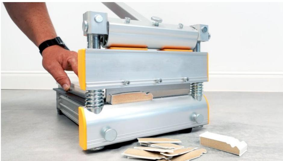
Das Profilschneidegerät ermöglicht millimetergenaue, saubere Schnitte ganz ohne Schattenfugen (Bild: Döllken).
