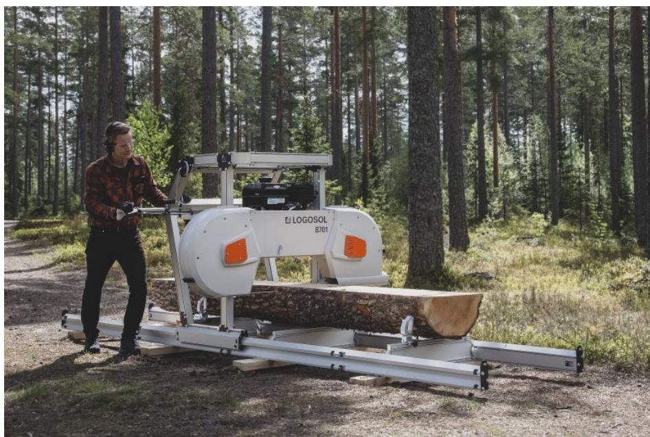
Das leistungsfähige und robuste Sägewerk wiegt nur 250 kg und ist dadurch sehr mobil (Bild: Logosol).
