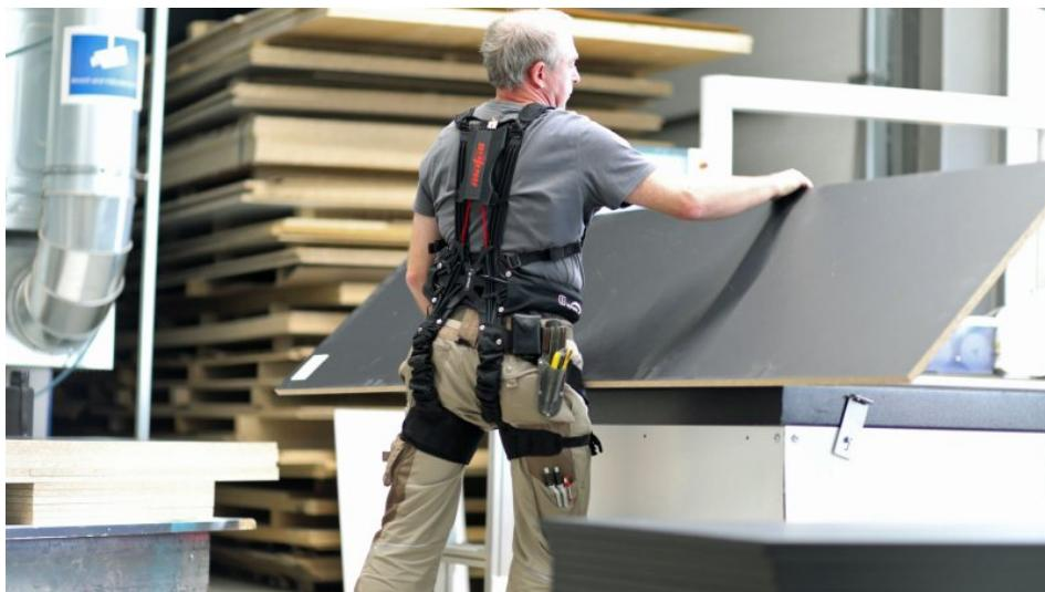
Die Hebehilfe entlastet dauerhaft den Rücken und andere stark beanspruchte Körperpartien (Bild: Mafell).
