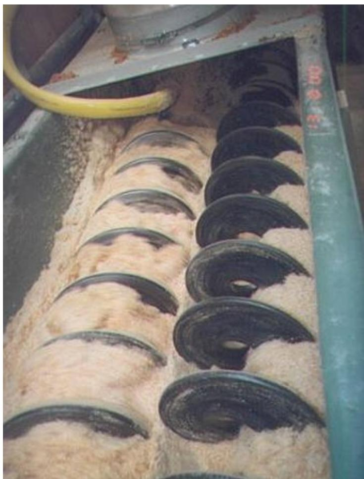
Mit den achsenlosen Förderspiralen erfolgt der Transport effizient und wartungsarm
