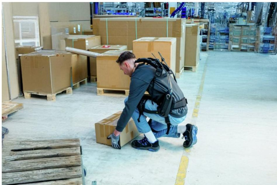
Das Rumpfbeuge-Exoskelett unterstützt den unteren Rücken beim Anheben und Ablegen von Gütern (Bild: J. Schmalz GmbH).
