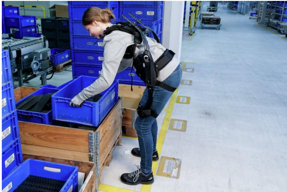
Das Rumpfbeuge-Exoskelett »Mate UBA« entlastet gezielt den unteren Rücken bei Hebetätigkeiten (Bild: J. Schmalz GmbH).
