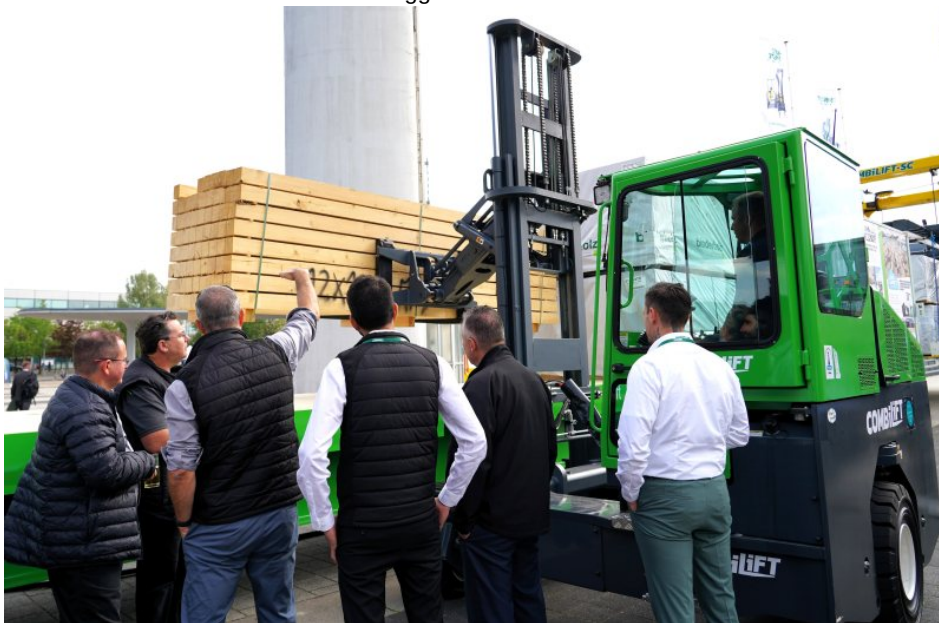
»Combi Load Xtender« ist ein scherenförmiger Ausleger zum platzsparenden und sicheren Be- und Entladen (Bild: Combilift).
