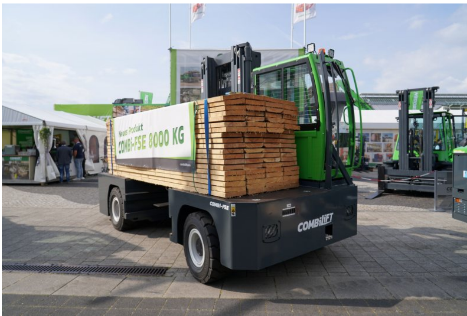
Der elektrische Vierrad-Seitenstapler »Combi-FSE 8000« verfügt über eine Tragfähigkeit von acht Tonnen (Bild: Combilift).
