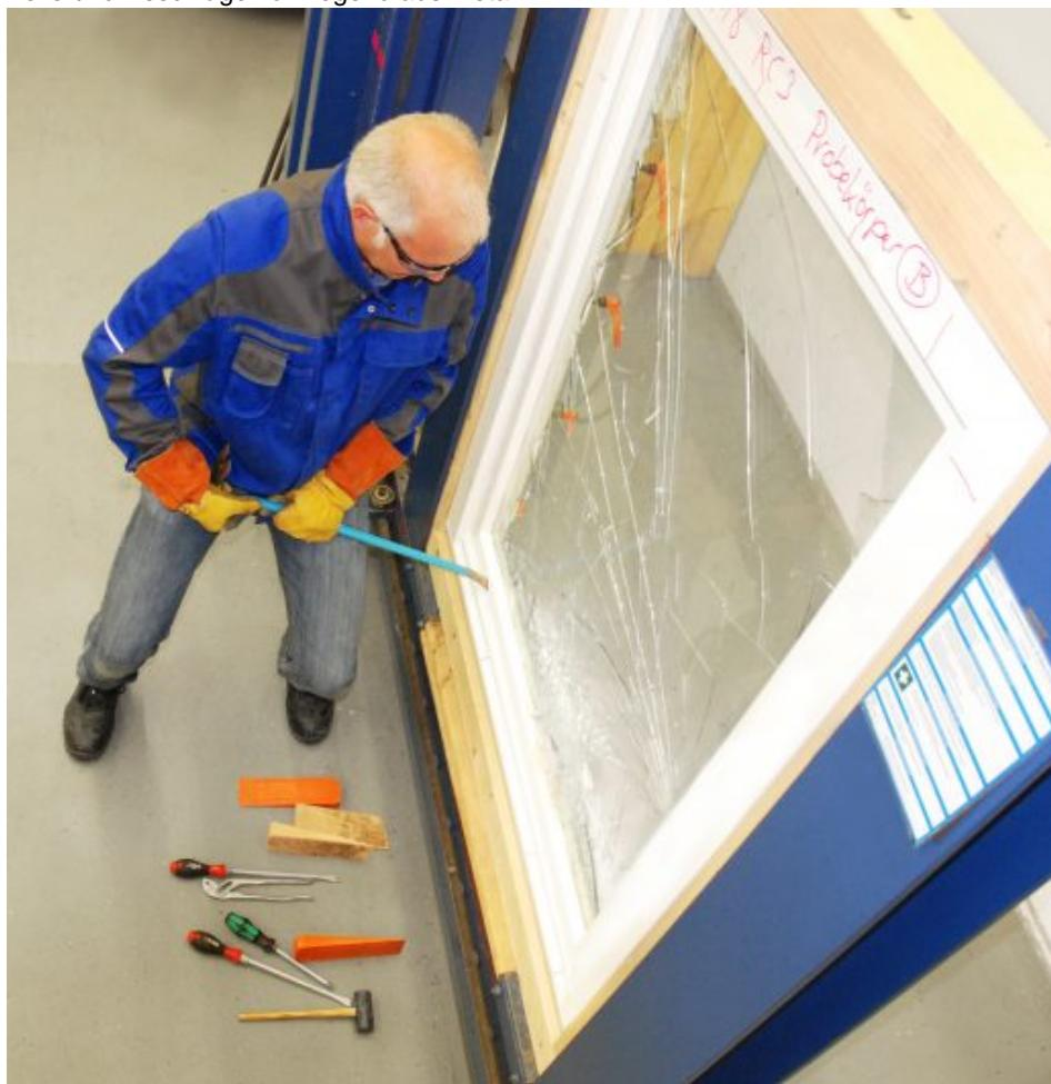
Mit dem steigenden Sicherheitsbedürfnis wächst vielfach der Wunsch nach mehr Einbruchhemmung am Fenster. Dem möchten Fensterprofis gern gerecht werden. Deswegen ergänzt Winkhaus das bereits bewährte Lizenzprogramm »activPilot Systemprüfungen Einbruchhemmung« jetzt mit RC3-geprüften Lösungen. Das
