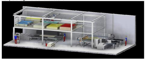
Das neue »Multilevel«-Plattenlager ermöglicht die effiziente Nutzung der vorhandenen Fläche. Bild: Barbaric
