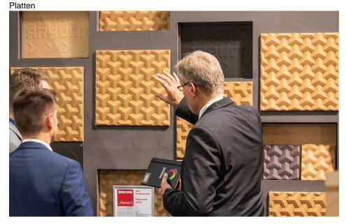
»3DF« von Sonae Arauco ist ein formbarer, formaldehydfreier Holzverbundwerkstoff, mit dem sich schnell und produktiv unzählige Formate herstellen lassen. Bild Sonae Arauco
