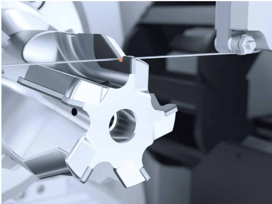
Die neue Drahterodiermaschine »VPulse 500« zum Schärfen von PKD-Werkzeugen.
