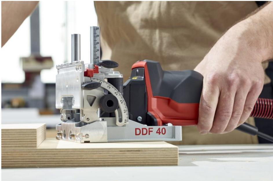
Mit dem »DuoDübler DDF 40« lassen sich nicht nur Dübelverbindungen erstellen, sondern auch Lochreihen und Löcher für Beschläge bohren. Bild: Mafell
