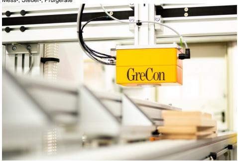
Das Messsystem bietet eine schnelle und genaue Messung der Dicke, des Flächengewichts sowie der daraus berechneten Dichte von Laborschnitten. Bild: Fagus-Grecon
